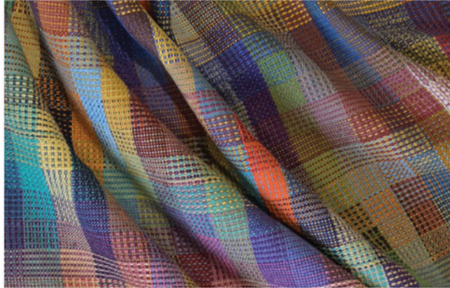
Figure 4 Crackle weave. 8 shafts. Venne 100% Organic Cottolin Nel 22/2. Filoeuvre.
