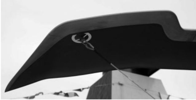
Figure 6.8 Merlin main rotor blade tip (BERP)
