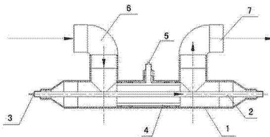
1. 一种养殖水体电处理装置,其特征在于:有壳体(1),在壳体(1)的中心线上设置有两端与壳体(1)相接的第一电极(2),所述第一电极(2)的一端有第一电极接头(3);在第一电极(2)的中间部位设有固定在壳体(1)内壁上的第二电极(4),与第二电极(4)接有穿过壳体(1)的第二电极接头(5);在所述第二电极(4)两端的壳体(1)上分别设有进水口(6)及出水口(7)。
