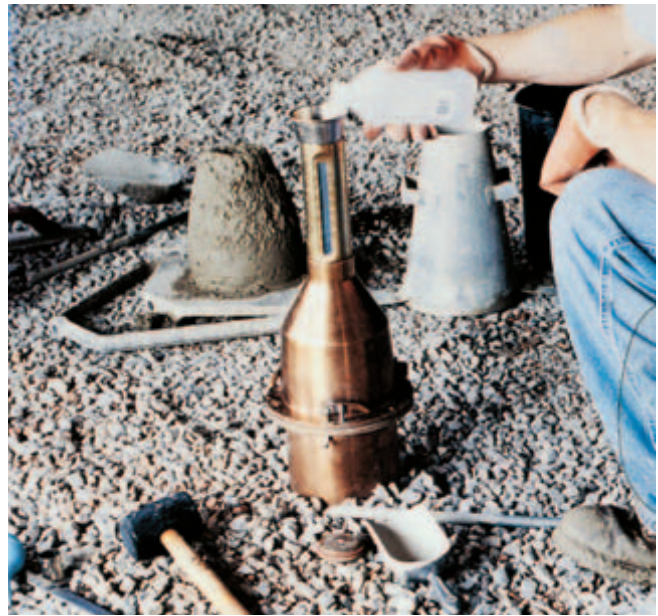
Fig. 16-6. Volumetric air meter. (IMG12200)
