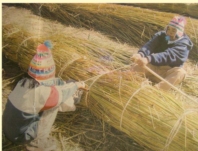
Fig. 6. Preparing the longitudinal cores.
